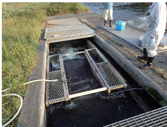
写真－2.2.4.13 遡上数自動計測システム
