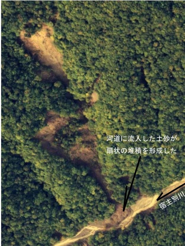
写真-1 宿主別川の斜面崩壊地と河道への流入土砂
