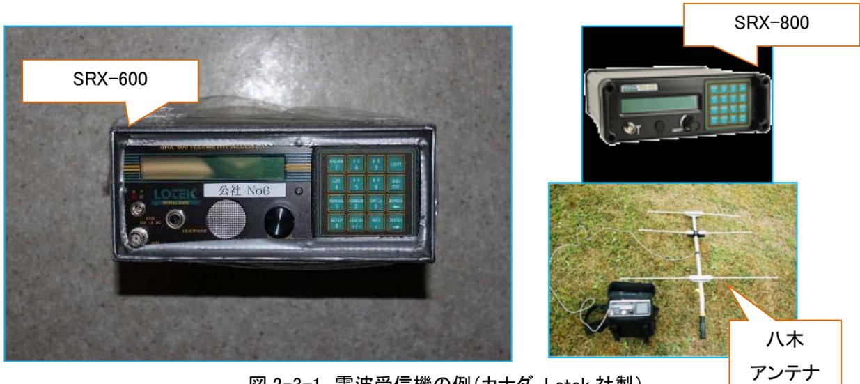
図 2-3-1 電波受信機の例(カナダ Lotek 社製)
