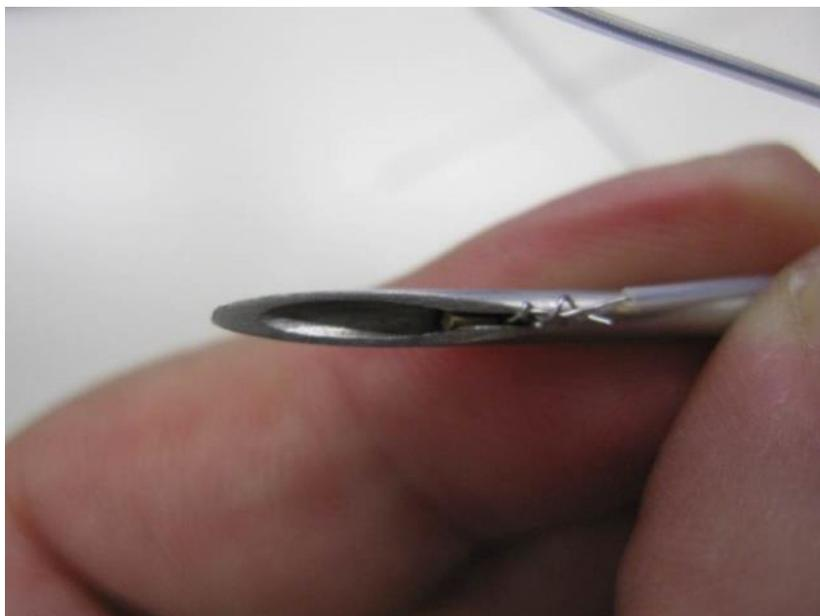
図 3-2-7 ニードルへの電極のアンカーの装着(切り込みに引っかける)
