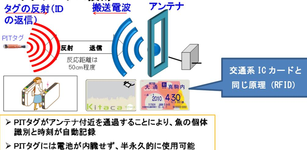
図 2-2-11 ピットタグシステムの概念
