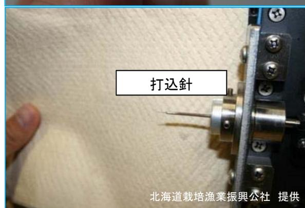
図 2-2-13 ワイヤータグの例(アメリカ NMT 社製:長さ 0.25mm)
