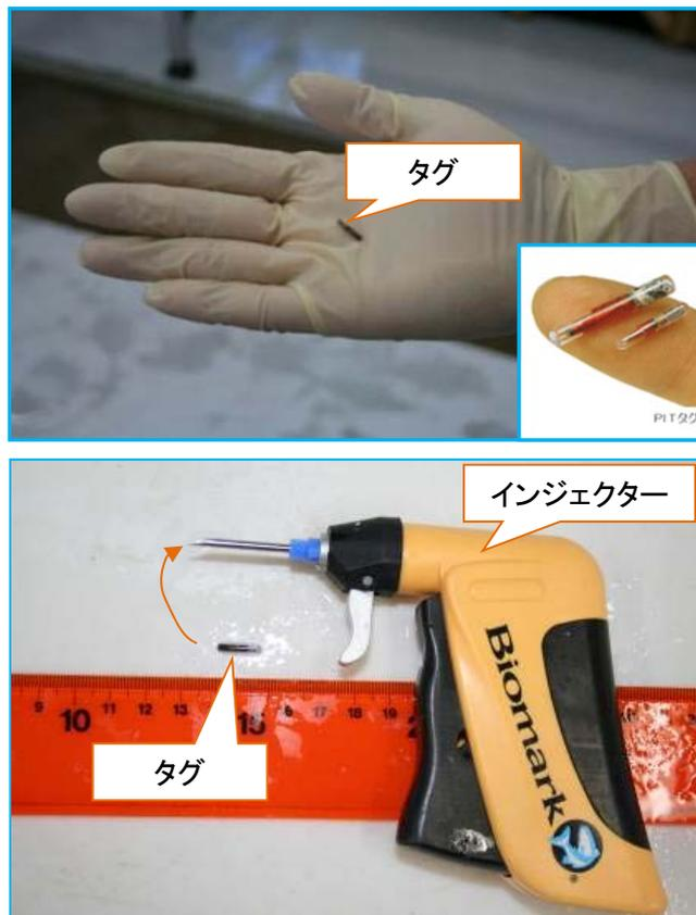
図 2-2-12 ピットタグの例(アメリカ バイオマーク社製:長さ 12.5mm 134.2 kHz 0.1g)
