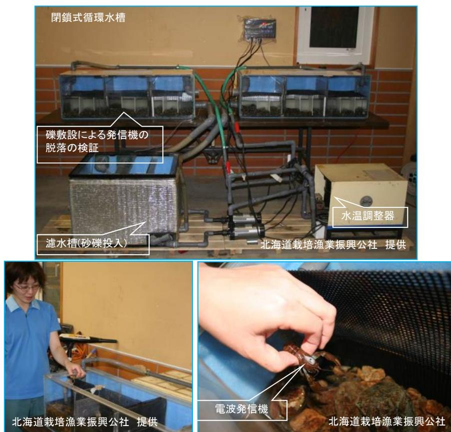
図 3-4-8 ザリガニ供試魚(電波発信機装着)の飼育試験(北海道栽培漁業振興公社資料より)
