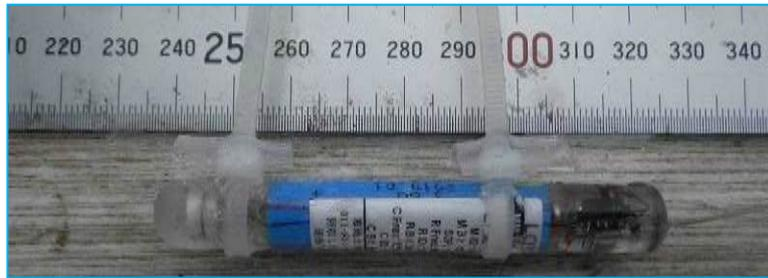
図 2-2-8 超音波・電波複合型発信機(カナダ Lotek 社製)
