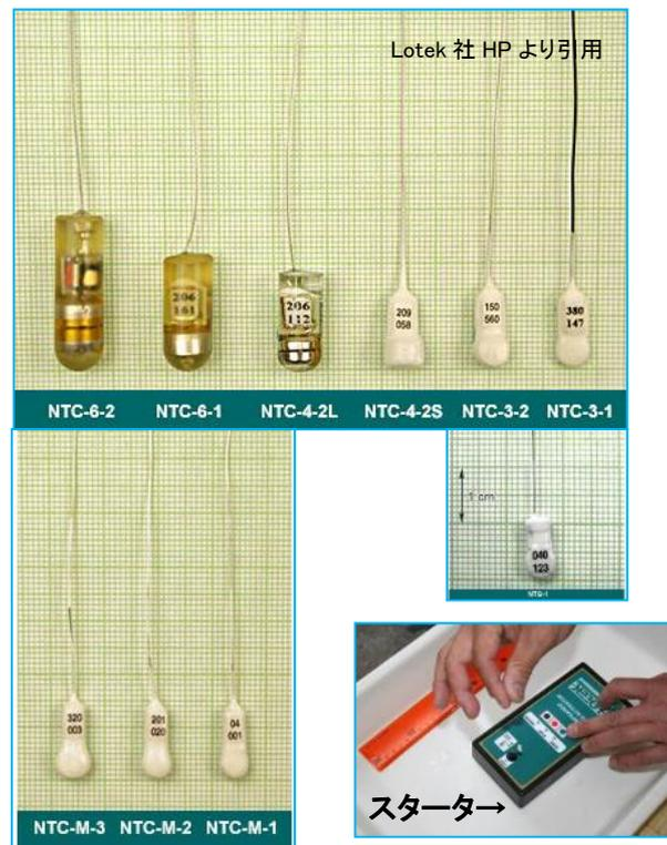
図 2-2-3 電波発信機の例(カナダ Lotek 社製、無線局免許申請の対象機種)
