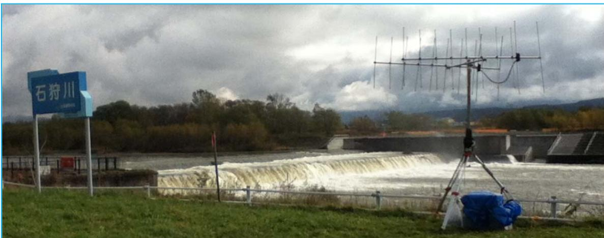
図 2-3-2 電波受信アンテナの例(土木研究所製 ATS システム)
