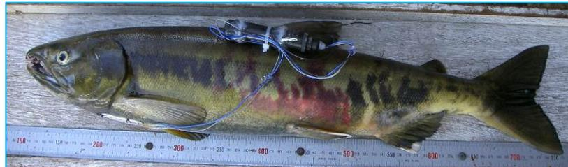
図 2-2-10 自記式心電位計測機の例
