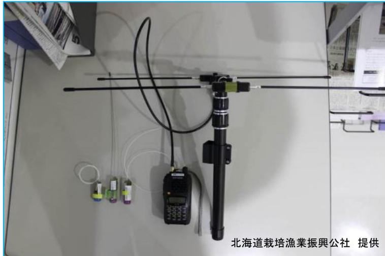
図 2-3-3 電波受信機の例(国産 サーキットデザイン社製)
