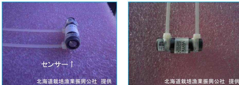
図 2-2-7 超音波発信機の例(カナダ Vemco 社製:69KHz 発信)
