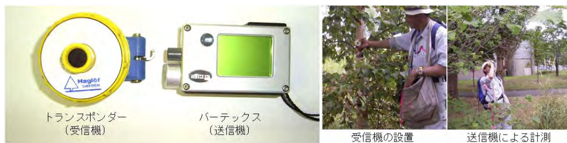
図 3-2-2 バーテックス機器(左)と使用状況(右)
