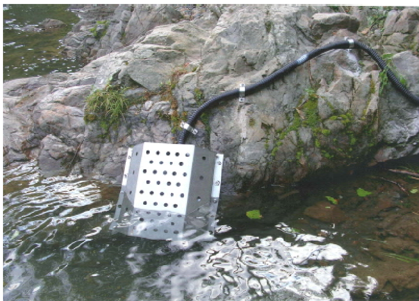
図ー1 濁度計保護ケースの事例（1）
