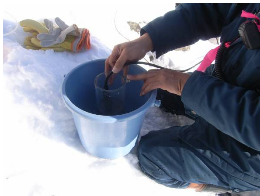
写真-2 直射日光、雪による反射光を遮蔽する容器を用いた現地でのキャリブレーション
