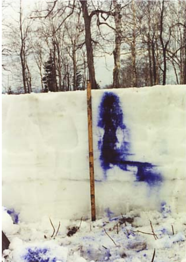
層境界では流れの集中化が起きる (写真は野村(1994)による)
